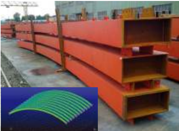
印度机库 India Hangar 主体结构: 为32m跨度弧形箱型钢梁 Subject structure: Curved box girder with 32m span
